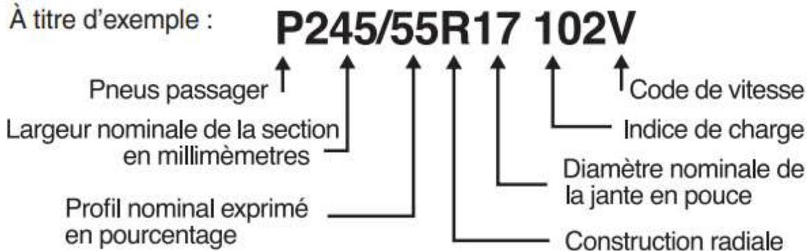
**Indice de charge,** un code numérique qui indique la capacité de charge maximale d'un pneu à la pression maximale de gonflage à froid.
